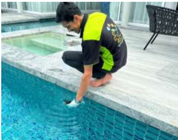
ภาพที่ 3.5.8-1 การเก็บตัวอย่างน้ำสระว่ายน้ำ
